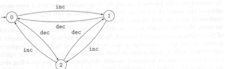
Fig. 1.2.  $\mathcal{A}_{c3}$  : a modulo 3 counter
